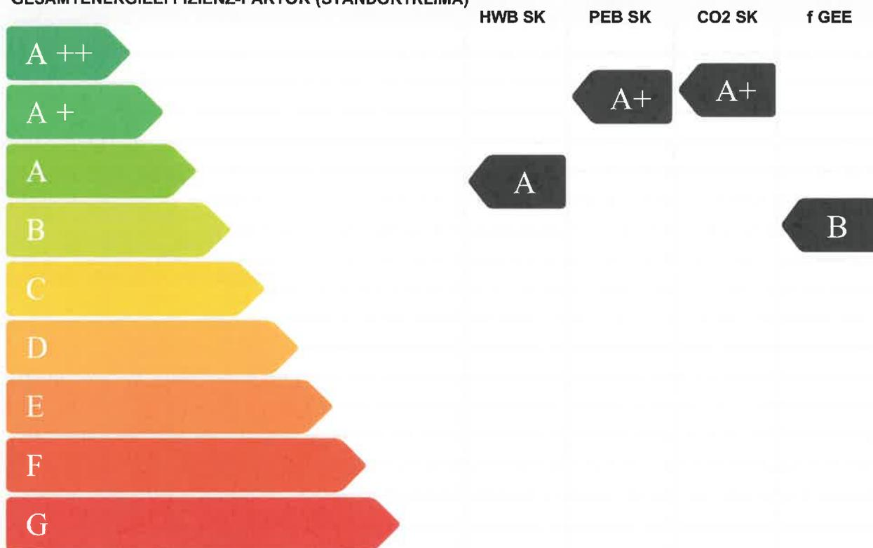
HWB: Der Heizwärmebedarf beschreibt jene Wärmemenge, welche den Räumen rechnerisch zur Beheizung zugeführt werden muss.
